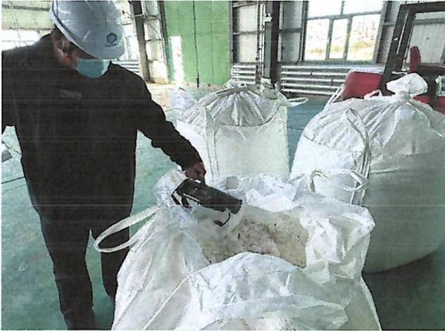
图 1 冶炼车间成品（偏钒酸铵）处检测
